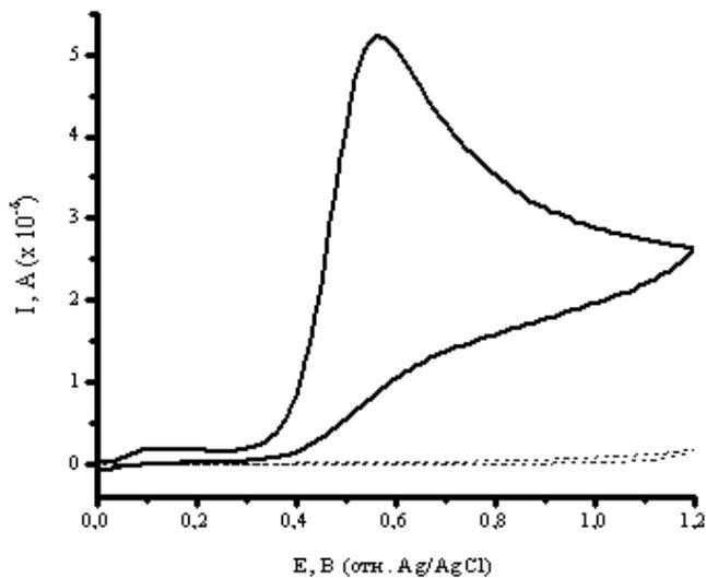
Рис. 1. Циклическая вольтамперограмма, полученная на ПГЭ в 0,1 М калий-фосфатном буфере, содержащем 50 мМ NaCl, рН 7,4, в отсутствие (---) и в присутствии (-) 1 мМ препарата А, скорость сканирования потенциала 0,08 В/с, шаг потенциала 0,01 В
